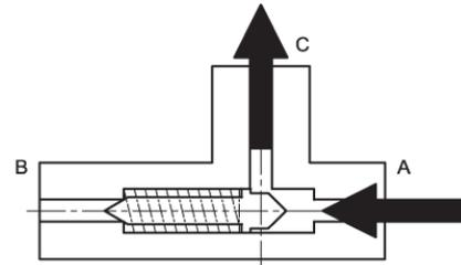
如果控制压力低于规定的开启压力，输入端 A 自动关闭。阀门回到排气位置：B 和 C 打开。
