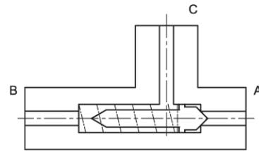
如果对控制输入端 A 施加工作压力，则输出端 B 关闭，控制介质可从连接端 C 流出。
