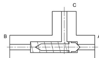
Wird der Steuereingang **A** mit dem Betriebsdruck beaufschlagt, schließt der Ausgang **B** und das Steuermedium kann an Anschluss **C** entnommen werden.
