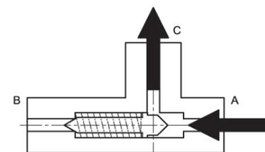
Fällt der Steuerdruck unter den angegebenen Öffnungsdruck schließt Eingang **A** automatisch. Das Ventil befindet sich wieder in der Entlüftungsposition: **B** und **C** sind geöffnet.
